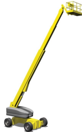
Mobil Boom (3b): Während des Einsatzes fahrbare Ausleger-Hubarbeitsbühnen
